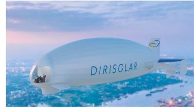
**CNIM Air Space** et RTE ont développé un dirigeable drone, nommé Diridrone. Destiné à l'inspection des lignes électriques haute-tension, Diridrone est un drone « plus léger que l'air », pouvant réaliser de manière automatique des vols sur de longues distances.
